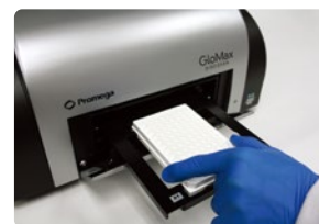
プレートの挿入方向
